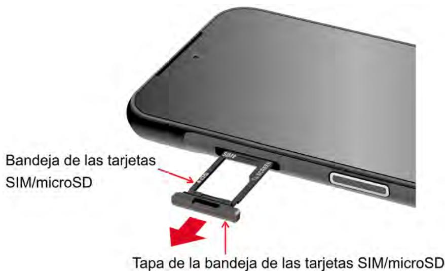
2. Pon la bandeja en una superficie plana y coloca una tarjeta microSD en la bandeja, con los contactos dorados hacia abajo como se muestra en el dibujo.
